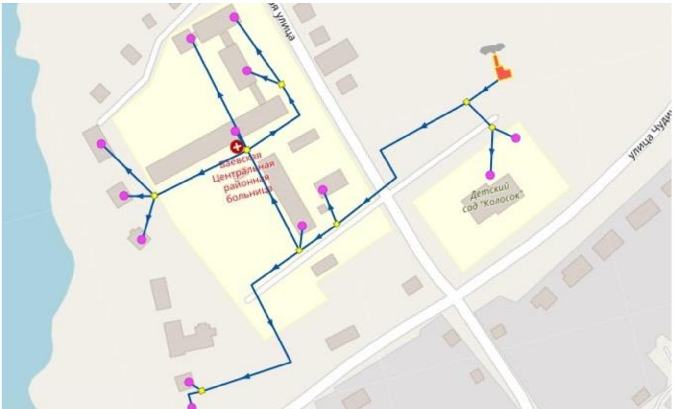
Рисунок 2.13 – Модель системы теплоснабжения котельной № 3 с. Баево
